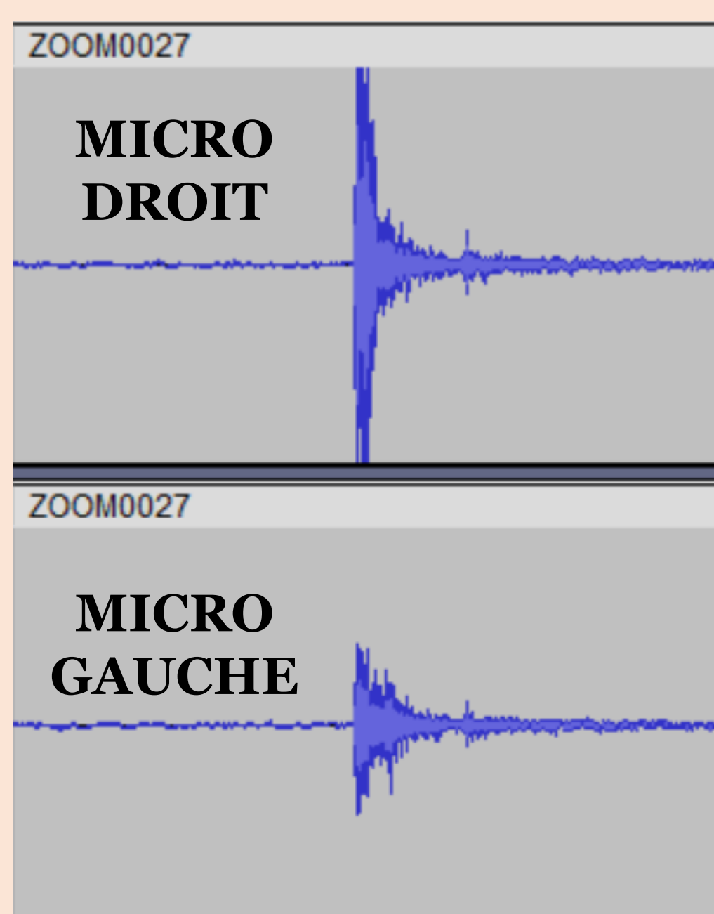
Figure 2b : Exemple d'un signal de clap cinéma sur Audacity (pour un angle de droite sur le schéma ci-dessus).
