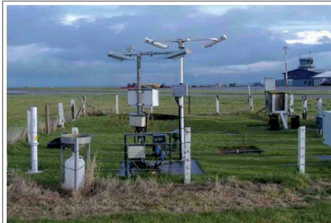
FIGURE 1 : Exemple typique d'un système automatisé d'observation des conditions au sol (ASOS [3]) localisé à proximité de la zone de toucher des roues d'un aéroport. Copie d'écran d'une partie de la page 97 de [6].
