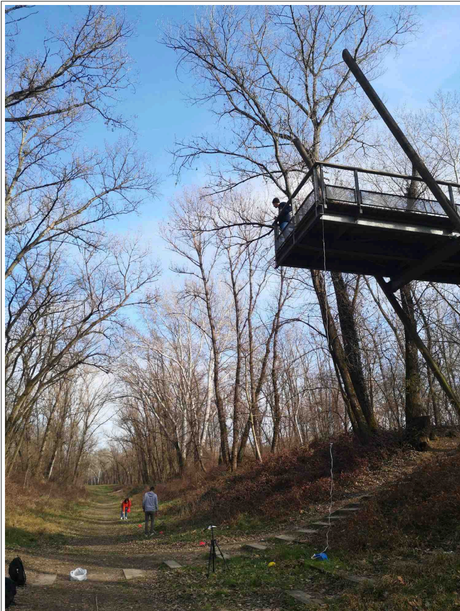
FIGURE 2 : Pour l'expérience avec les glands, une passerelle du parc naturel urbain de la FEYSSINE à VILLEURBANNE a été utilisée pour les faire chuter d'une hauteur donnée.
